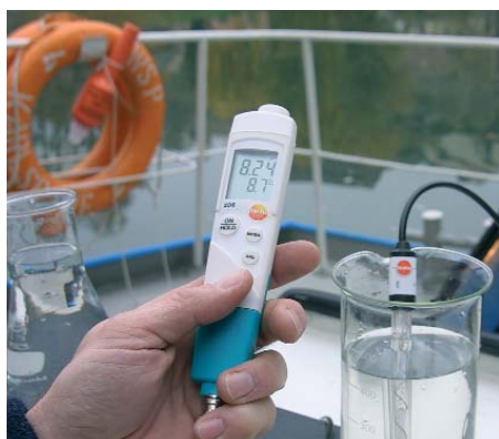
Automatická teplotní kompenzace u sond vybavených teplotním senzorem
