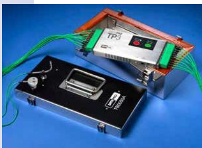
AutoPaq 20 kanálový systém (TP3026 a TB0050)
